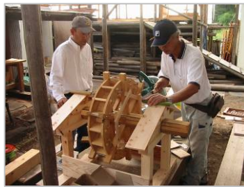
水車の仮組みをしています
