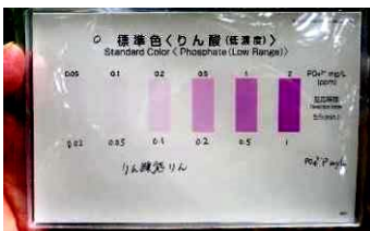
硝酸態窒素とリン酸の調査時に使用する判断用の標準色一覧
